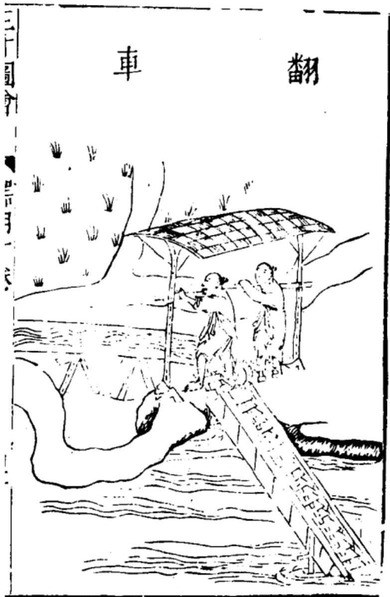
翻車今人謂龍骨車也魏畧曰馬鈞作翻車又漢靈帝使畢嵐作翻車其車之制除壓欄木及列檻樁外車身用枳作槽長可二丈濶則不等或四寸至七寸高約一尺槽中架行道板一條隨槽濶狹比槽板兩頭俱短一尺用置大小輪軸同行道板上下通過以龍骨板葉其在上大軸兩端各帶拐木四莖置於岸上木架之間人憑架上踏動拐木則龍骨板隨轉循環行道板刮水上岸此制閼捷頗多必用木匠可易成造其起木之法若岸高三丈有餘可用三車中間小池倒都船切水上之足救三丈
