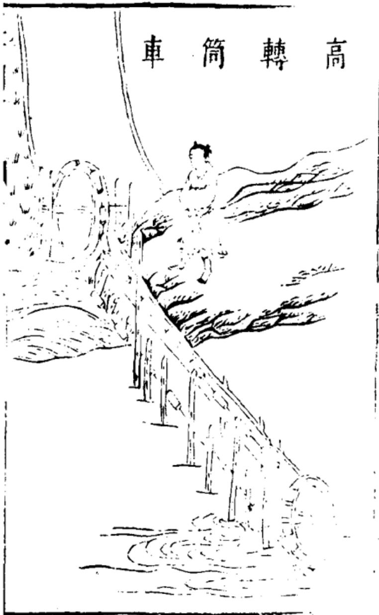
高轉筒車其高以十丈爲準上下架木各豎一輪下輪半在水內各輪徑可四尺輪之一周兩傍高起其中右槽以受筒索其索用竹均排三股通穿爲一隨車長短如環無端索上相離五寸俱置竹筒筒長一尺筒索之底托以木牌長亦如之通用鐵線縛定隨索列坎絡於上下二輪復於二輪筒索之間架剗口稱切水平底行槽一連上與二輪相平以承筒索之重或人踏或牛拽轉上輪則筒索自下兜水循槽至上輪輪首覆水空筒復下如此循環不已日所得水不減平地車耳
