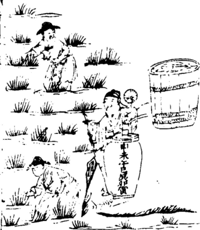
田漏田家測景水器也凡寒暑昏曉已驗於星石占候時刻惟漏可知古今刻漏有二曰稱漏曰浮漏夫稱漏以權衡作之殆不如浮漏之簡要今田漏槩取其制置箭壺內刻以爲節既壺水下注則水起箭浮時刻漸露自己初下漏而測景焉至申初爲三時得二十五刻倍爲六辰得五十刻畫之於箭視其下尚可增十餘刻也乃於卯酉之時上水以試之今日午至來日午而漏與景合且數日皆然則箭可用矣如或有差當隨所差而損益之改畫辰刻又試如初必待其合也農家置此以揆時計工不可闕者大
